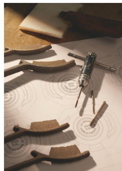
3. Au stade de la conception, des dessins techniques précis sont transformés en outillage particulier, utilisé pour créer les moules en sable dans lesquels la fonte en fusion est coulée.
