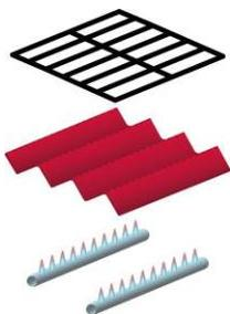
🔥 La chaleur se répartit uniformément sur toute la grille et permet aux grillades de rester juteuses. La plaque émettrice unique constitue le cœur de la TRU-Infrared™ Technology. Grâce à elle, la chaleur tournante dans la chambre de combustion est transformée en chaleur rayonnante TRU-Infrared™. Elle recueille le jus de cuisson qui s'évapore et est restitué directement à l'aliment à griller. Ainsi, celui-ci ne s'assèche pas.
