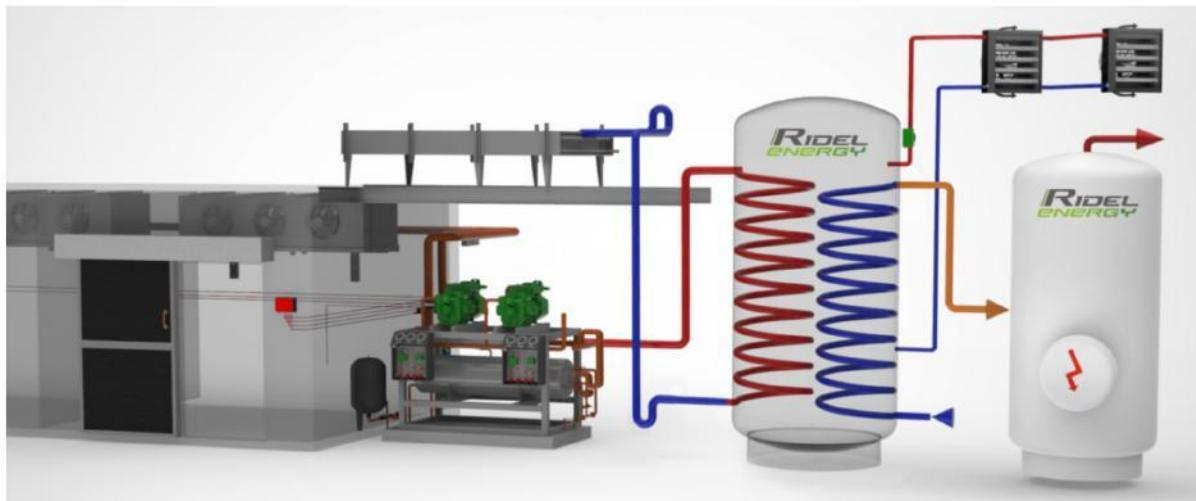
Les équipements Ridel-Energy permettent de **récupérer les chaleurs rejetées** par les systèmes de production de froid afin de **produire de l'eau chaude gratuitement** pour répondre à des besoins de process, d'eau chaude sanitaire et/ou de chauffage.
